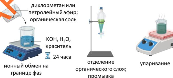
Рис. 1. Схема получения ацидохромных ионных жидкостей.
